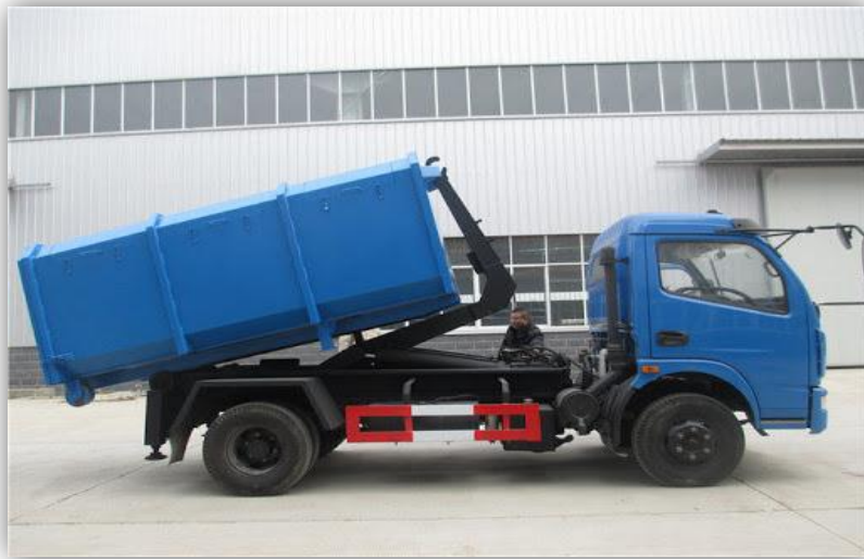
الصورة رقم 07: توضيح شاحنة ذات أثر هيدروليكي.
