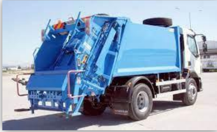
الصورة رقم 06: توضيح شاحنة جمع ذات هيكل مغلق ونظام ضغط.
