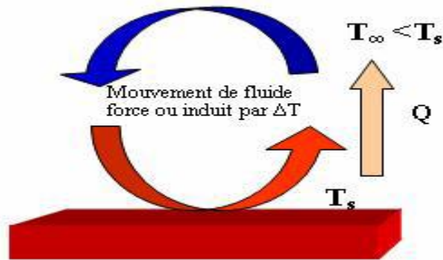
Fig I.2: Schéma du phénomène de transfert de chaleur par convection.[3]
