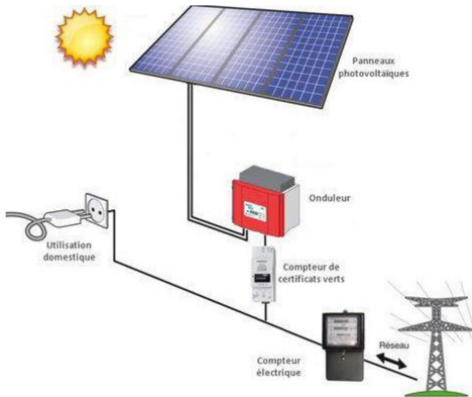
Figure I.12 Système PV connecté au réseau électrique.
