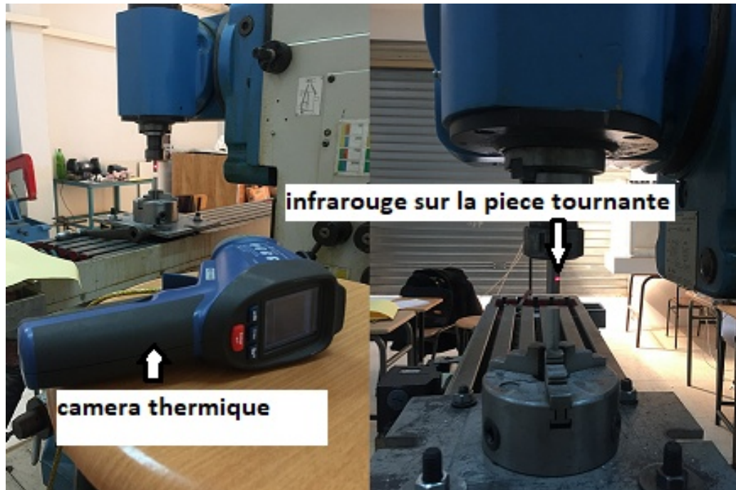
Figure III.3. Mesure de température des joints par une caméra thermique infrarouge
