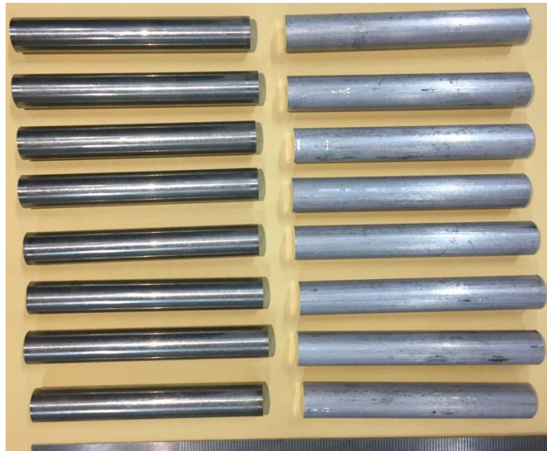
Figure III.1. Pièces d'aluminium 2017A et d'acier inoxydable AISI 316L à assemblée par soudage par friction rotative
