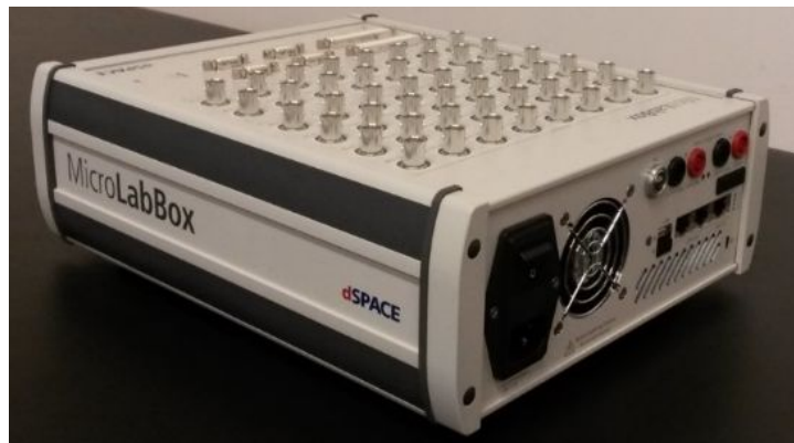
Figure (IV.4) : Photo de la carte dSPACE MicroLabBox
