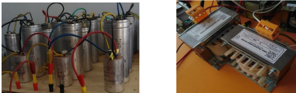
Figure (IV.17) : Photo des condensateurs et des inductances du filtre LC.
