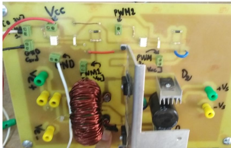
Figure (IV.3) : Photo de deux bras du convertisseur boost (un seul bras est utilisé).
