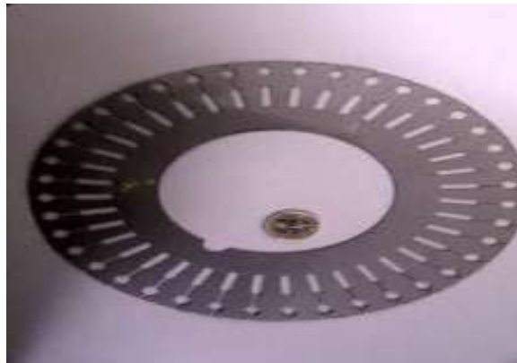
Fig. 1.5 Tôle utilisée pour la réalisation d'une cage à double encoche
