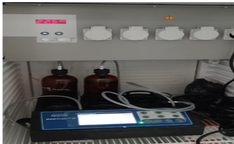
Figure 34 : Le DBO mètre utilisé dans STEP de sidi Aissa
