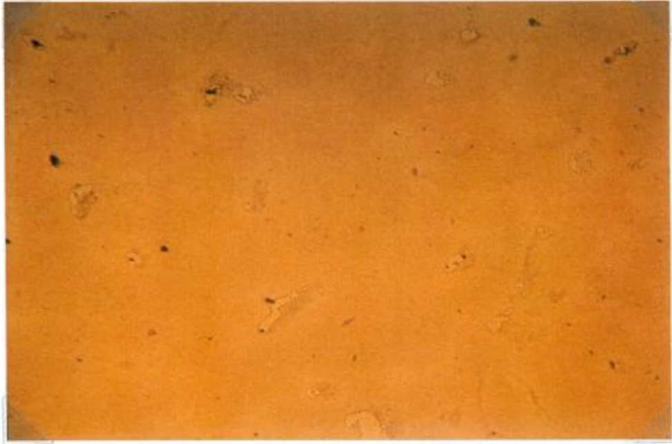
Figure 3.13 : Acier au manganèse à l'état Trempé avant polissage (grossissement x 100) [3].
