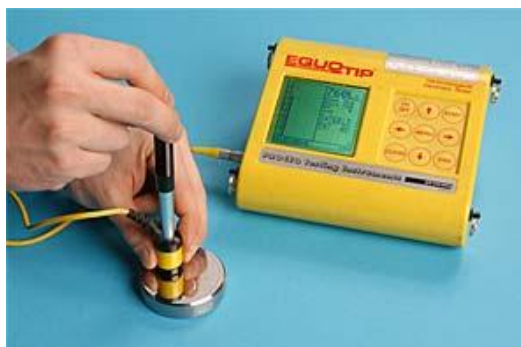
Figures 3.28 : méthode d'application d'un duromètre de marque Equotip 2.
