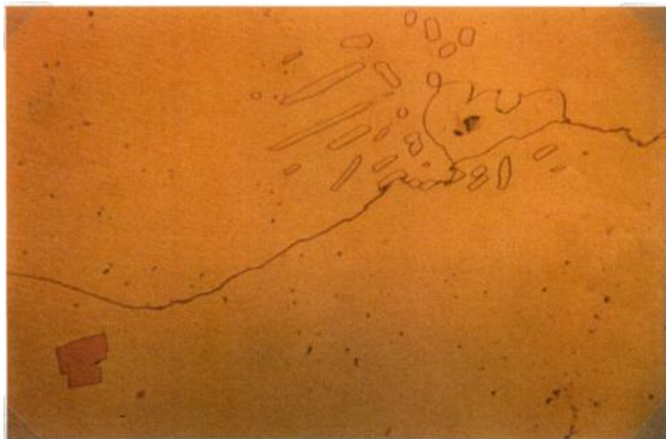
Figure 3.14 : Acier au manganèse à l'état Trempé après le polissage (grossissement x 100) [3]
