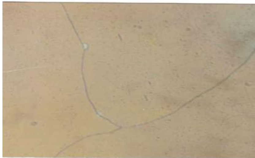
Figure 3.9 : Acier au manganèse à l'état de trempe avec un grossissement x 300 [3]
