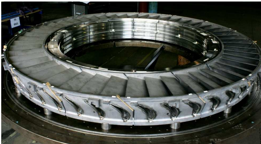
Figure II.5-b : Position de la directrice par rapport au centre de turbine.
