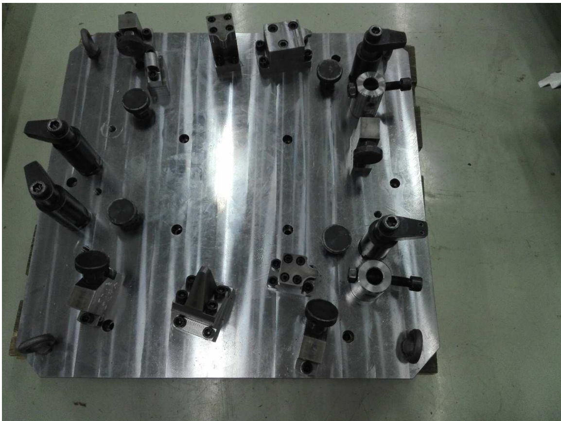
Figure IV.13-b : Montage pour la face_1 en réel.
