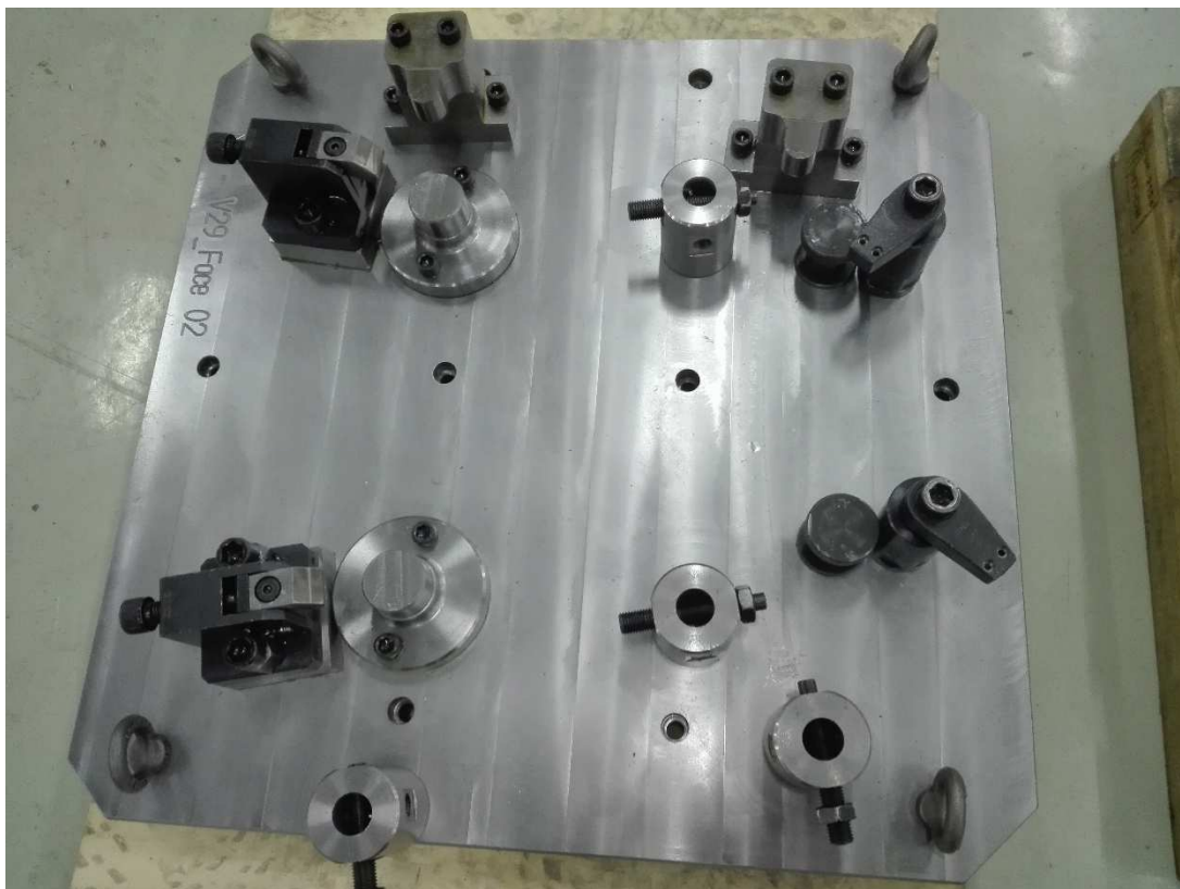
Figure IV.13-d : Montage pour la face_2 en réel.
