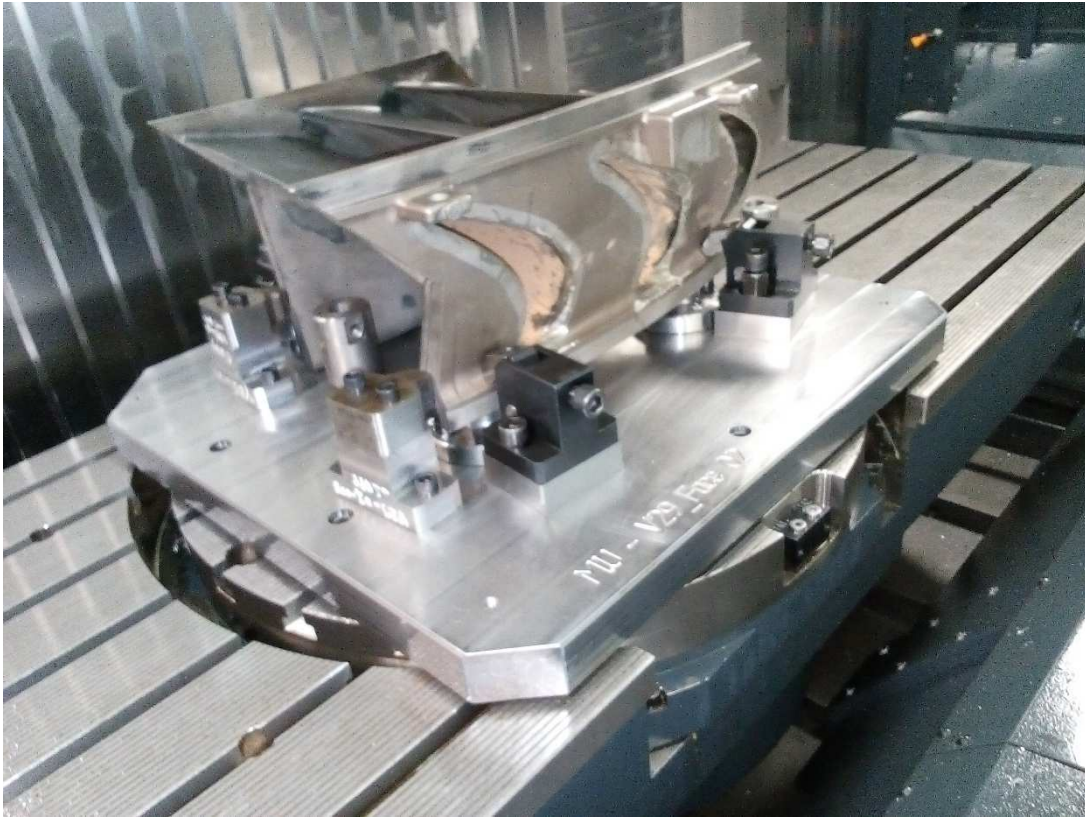
Figure IV.13-e : Photo du montage durant l'usinage de la face_2.
