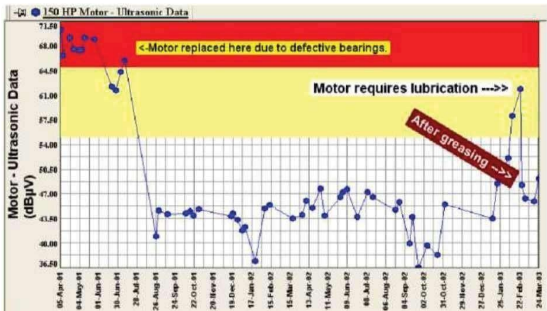
Figure II.9 schéma de Contrôle ultrasonique d'un moteur.
