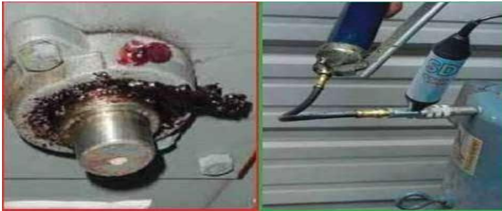
Figure II.11 Graissage d'un roulement Par US.
