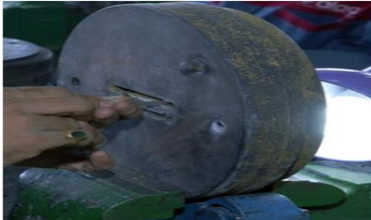
Figure Error! No text of specified style in document..5. L'opération de correction de filières.
