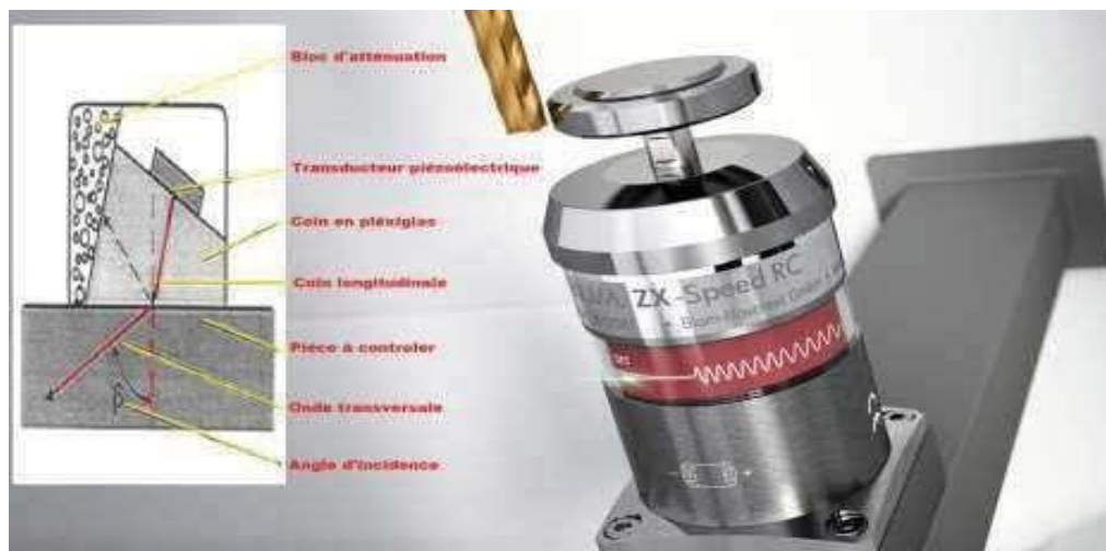
Figure II.8 Structure d'un palpeur pour ondes transversales.
