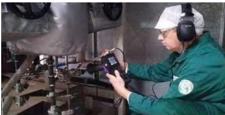
Figure II.10 Contrôle ultrasonique d'un moteur
