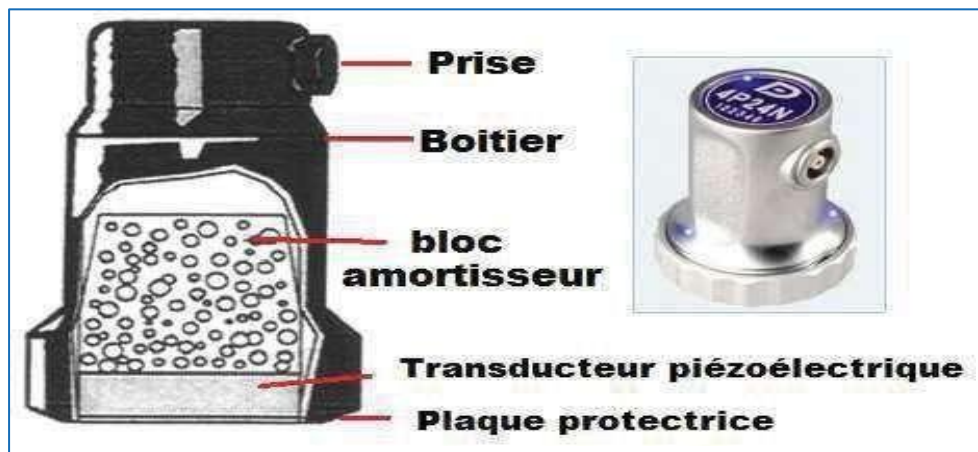
Figure II.7 ; Structure d'un palpeur pour ondes longitudinales.
