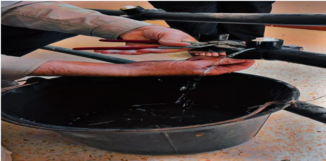
Figure III.12. Casse d'un clapet au cours des essais
