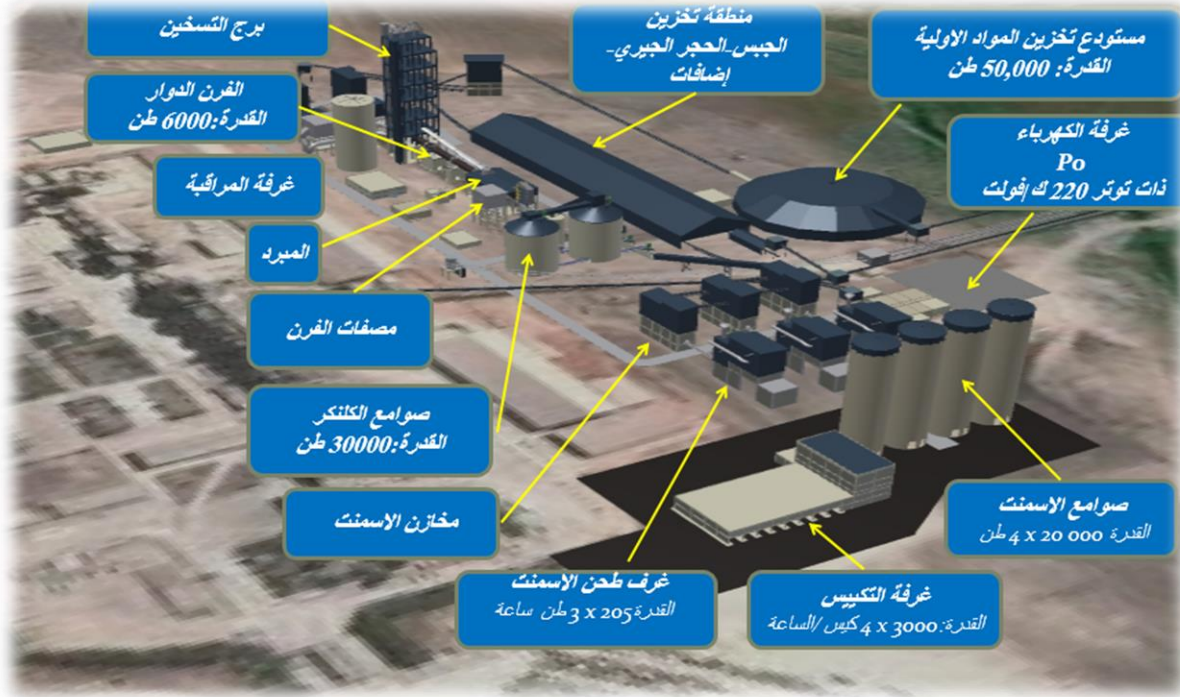
الشكل 12: مكونات مصنع الاسمنت
