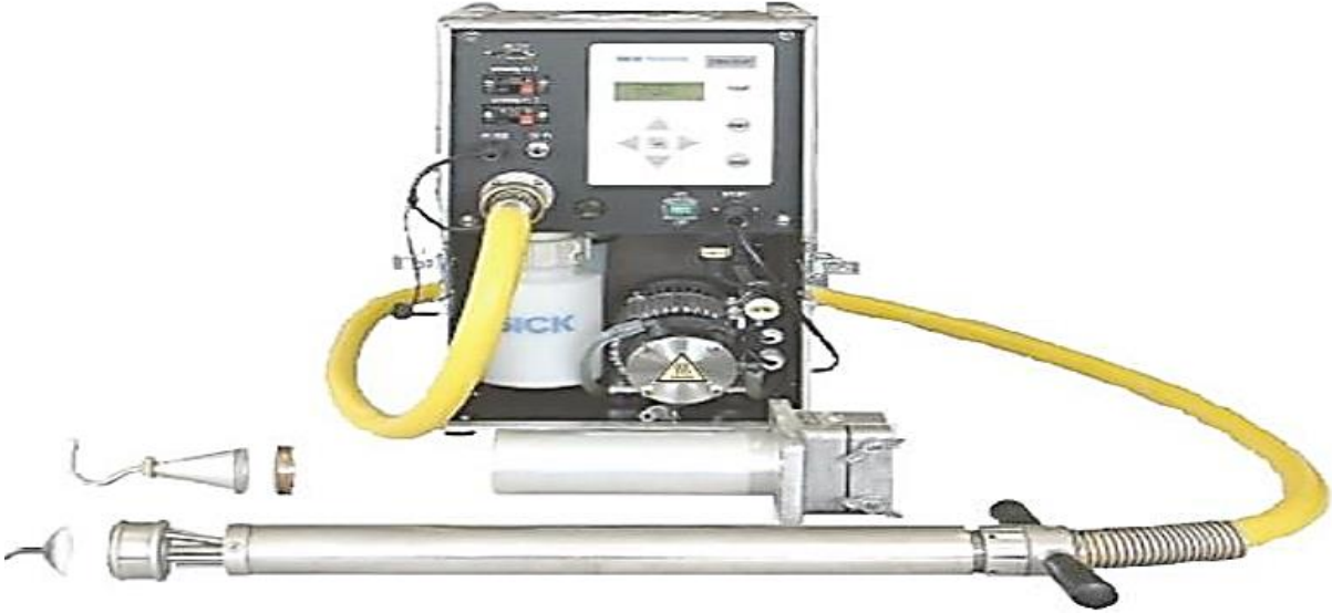
الصورة 25: جهاز قياس حجم الغبار
