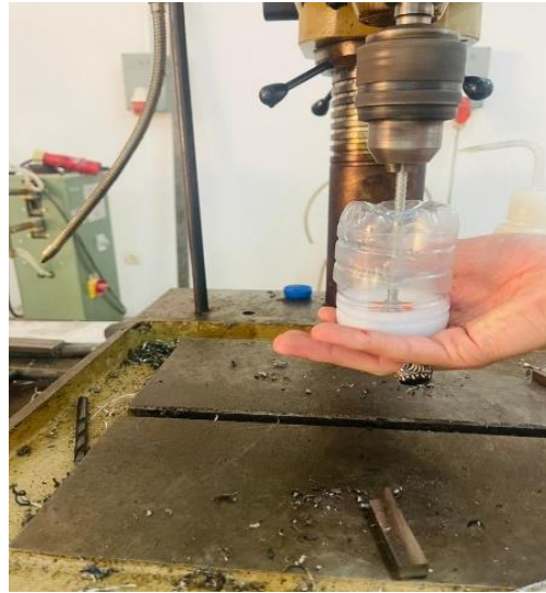
Figure 10.II.2 :Mécanisme utilisé pour mélanger la résine avec la poudre d'alumine.
