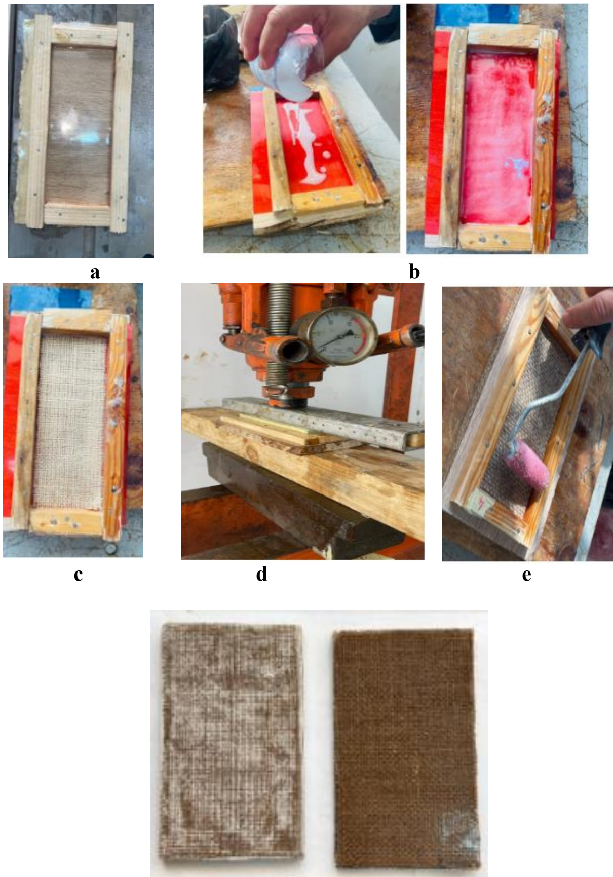
Figure 11.II.3: Différentes étapes de la fabrication du composite hybride.
