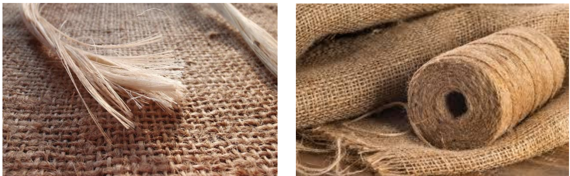
Figure.I.8: Fibres et tissus de jute.
