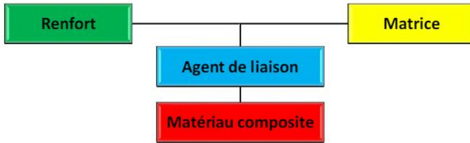
Figure I.1 : Constituants d'un matériau composite.
