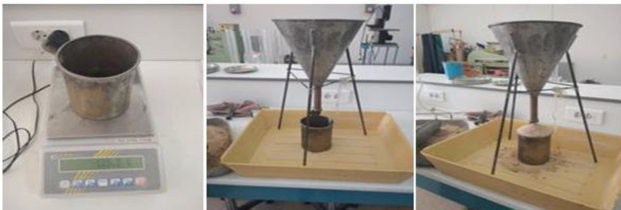
Figure III .2: Essai de masse volumique absolue de sable
