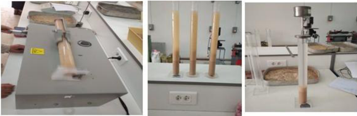
Figure III.7: Essai de l'équivalent de sable
