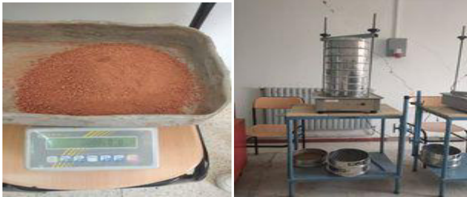
Figure III.11: Essai d'analyse granulométrique de sable de brique
