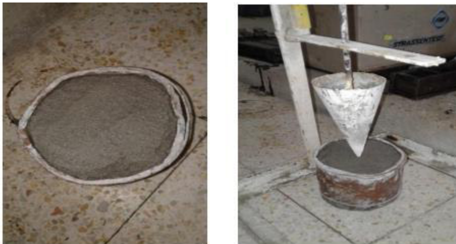
Figure III.19:Mesure de la fluidité du mortier.
