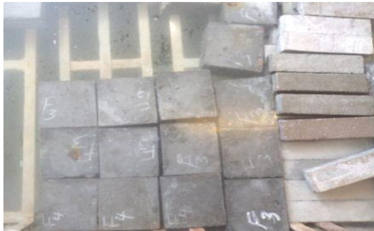
Figure III.17: Conservation des éprouvettes dans l'eau.
