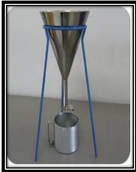
Figure (II.8): Essai de détermination de la masse volumique apparente.
