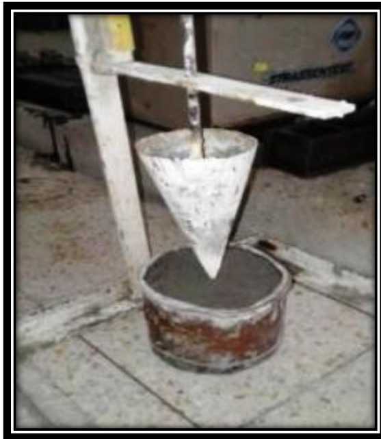
Figure III.6 : Mesure de l'affaissement du mortier.
