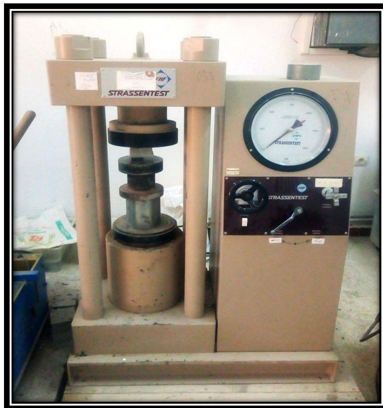
Figure(III.9) : L'appareil de l'essai de compression.
