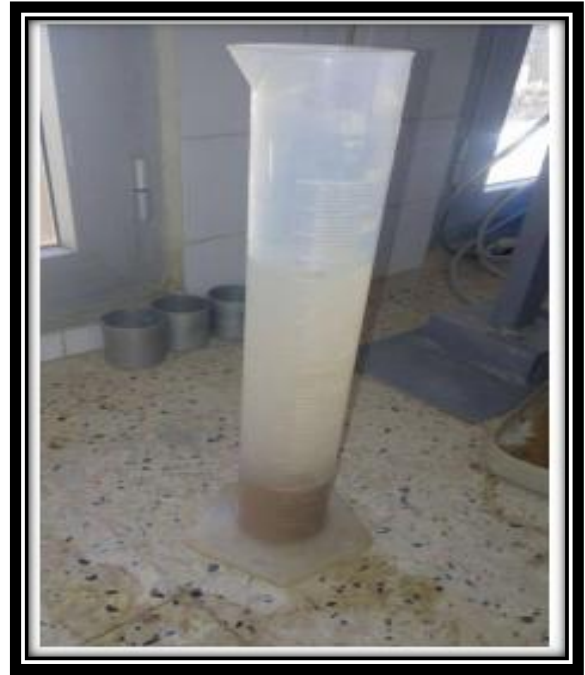
Figure (II.7) : éprouvette graduée de la détermination de la masse volumique absolue.
