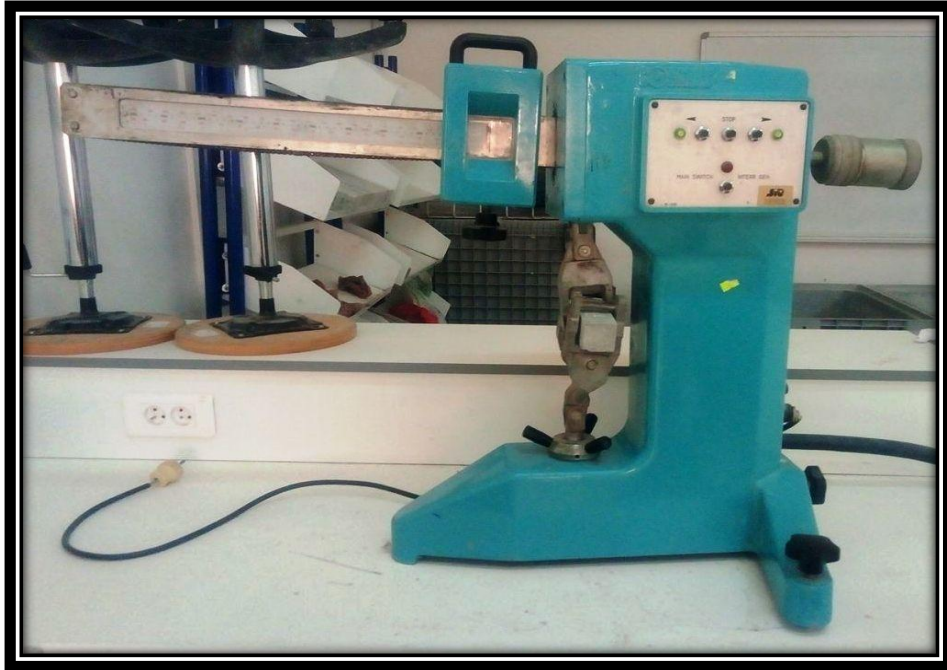
Figure(III.8) : L'appareil de l'essai de traction par flexion.
