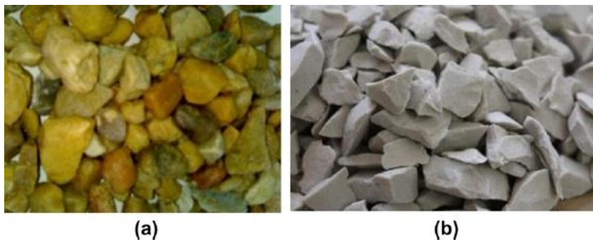
Fig.III.16. a) gravier naturel ; b) gravier céramique.
