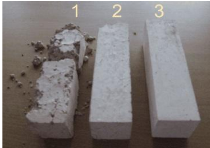
Fig.III.11. Après les cycles chauffage, séchage ; 1. granulats calcaires ; 2. granulats granitiques ; 3. granulats céramiques[28 ]
