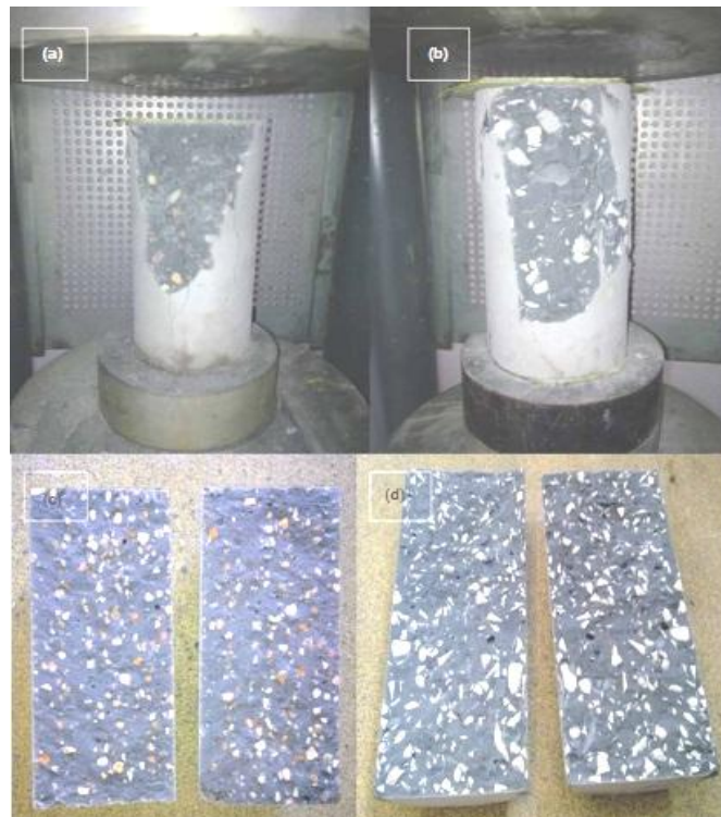
Fig.III.8. Formes de fracture.
