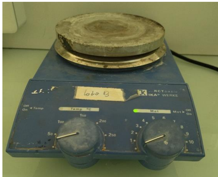
Figure 6 : Image photographique de l'agitateur magnétique
