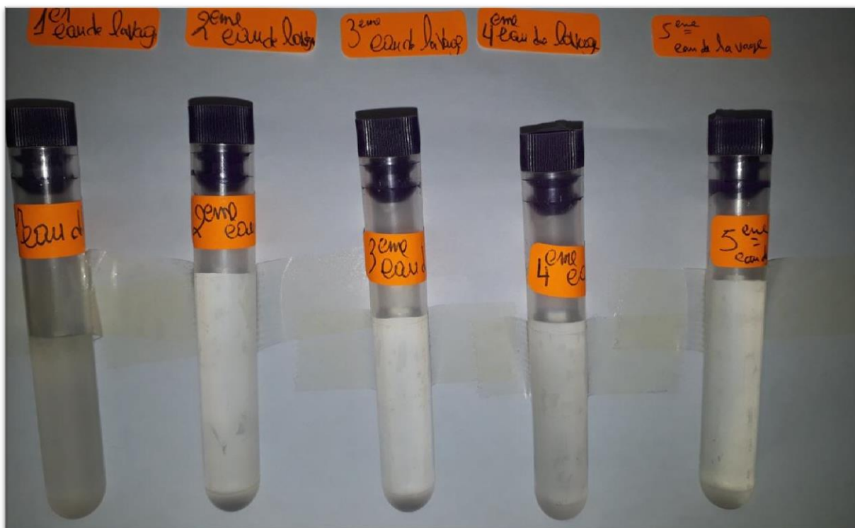
Figure.II.1 : Test de confirmation d'absence de chlore par déférente de lavage
