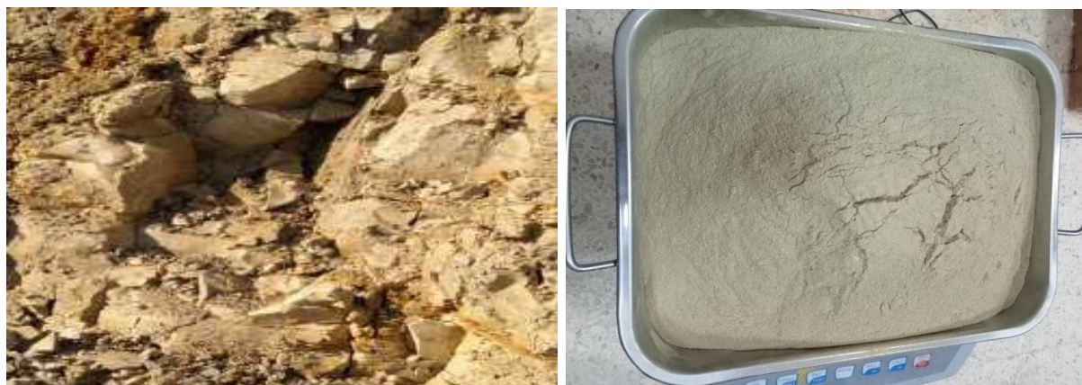
Fig. 3.2 : Aspect du sol de Sidi Hadjres a) intact, b) broyé
