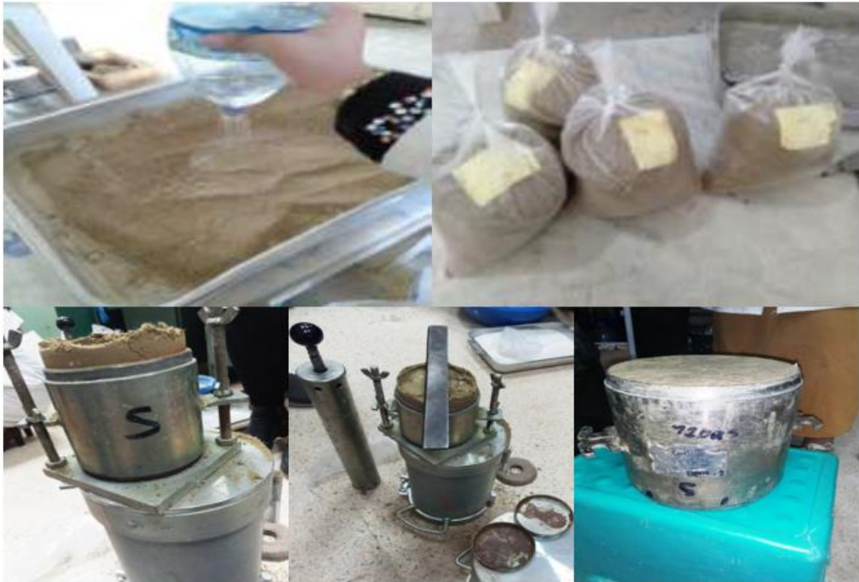
Fig. 3.5 : Préparation des essais de compactage
