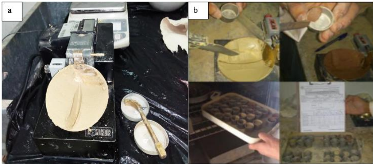
Figure. 3.7 : (a) : pratiqué la rainure et crée une serré de choes jusqu'à la fermeture des lèvres, (b) : prélèvement d'échantillon et dessiccation à l'étuve.
