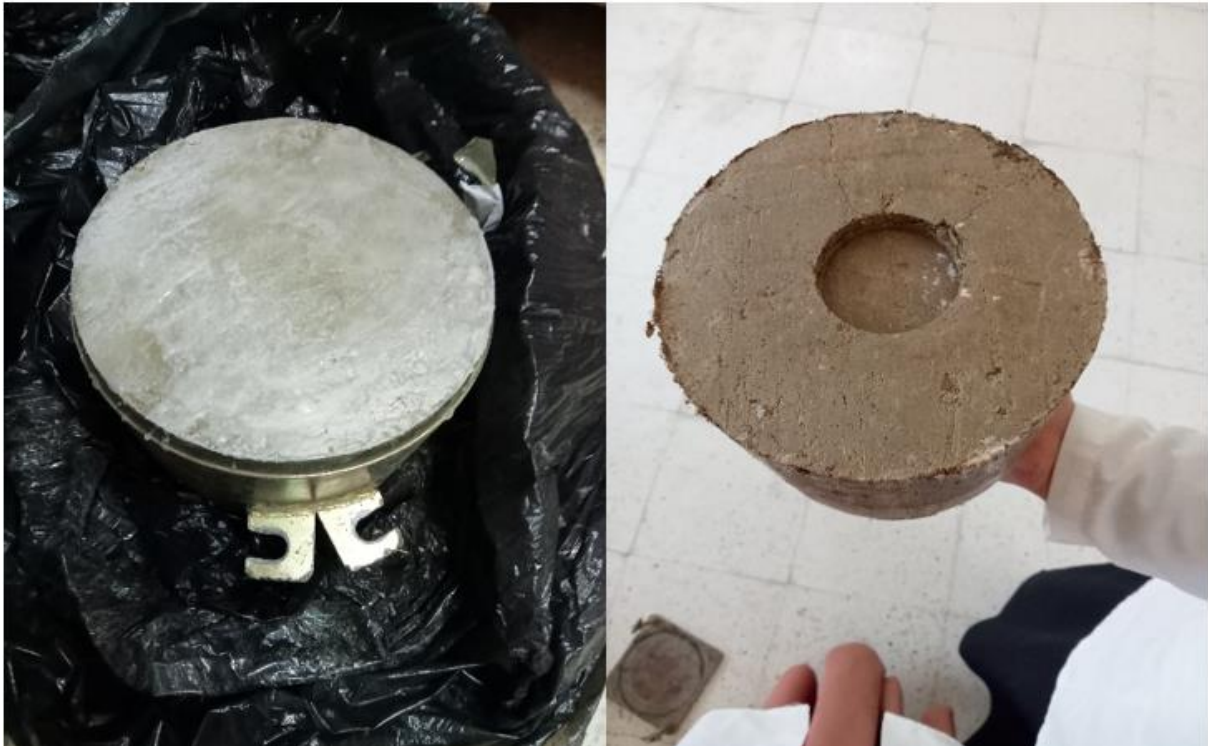
Fig. 3.10 : Les éprouvettes de CBR avant et après l'exécution de l'essai.
