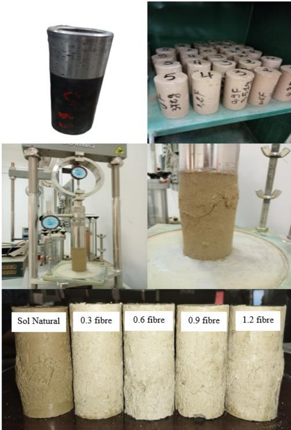
Fig. 3.6 : L'essai de compression
