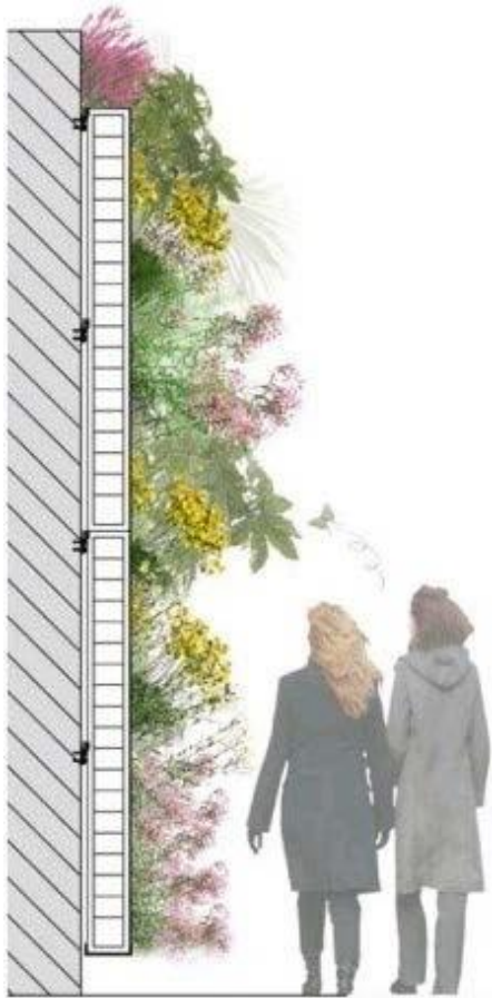
Figure I. 10 -schéma explicatif Mur végétalisé. source AMC architecture.2023
