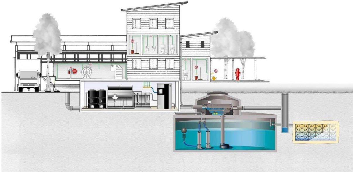
Figure I. 30. schémas des systèmes de récupération d'eau de pluie pour particuliers, entreprise et collectivités.
