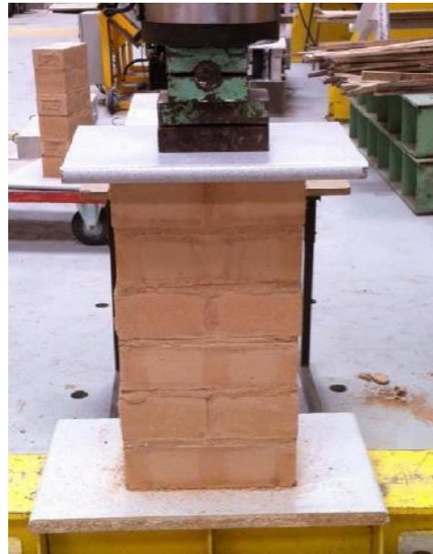
Fig14 :. Principe de l'essai de compression sur mure
