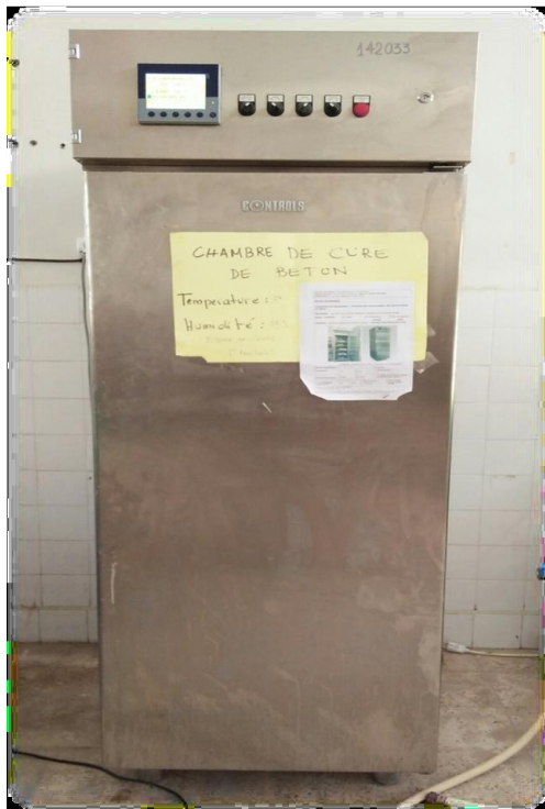
Fig 4: chambre de cure (du laboratoire de développement Géo matériaux Université de M'sila).
