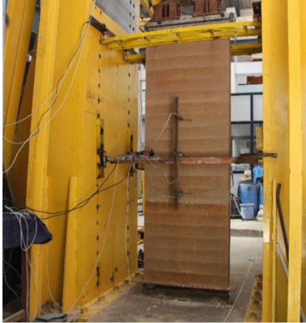
Fig21 : Test de compression mise en place pour le mur CSRE
