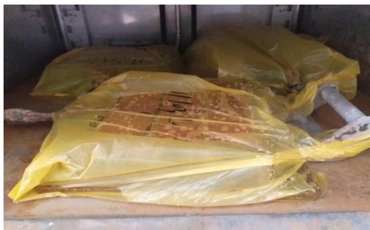
Fig3 : la cure des éprouvettes Avant démoulage 0-24 h
