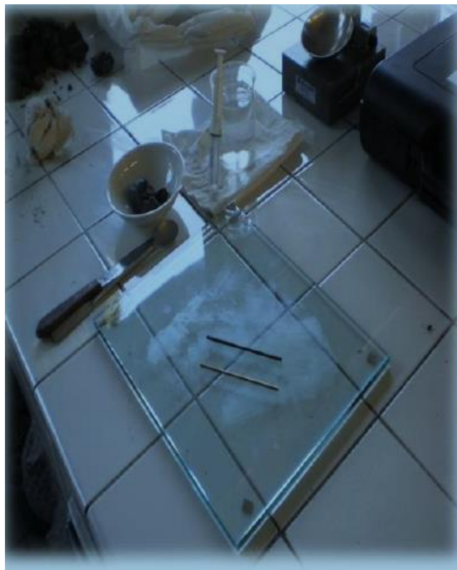
Fig11 : Limite de plasticité au rouleau
