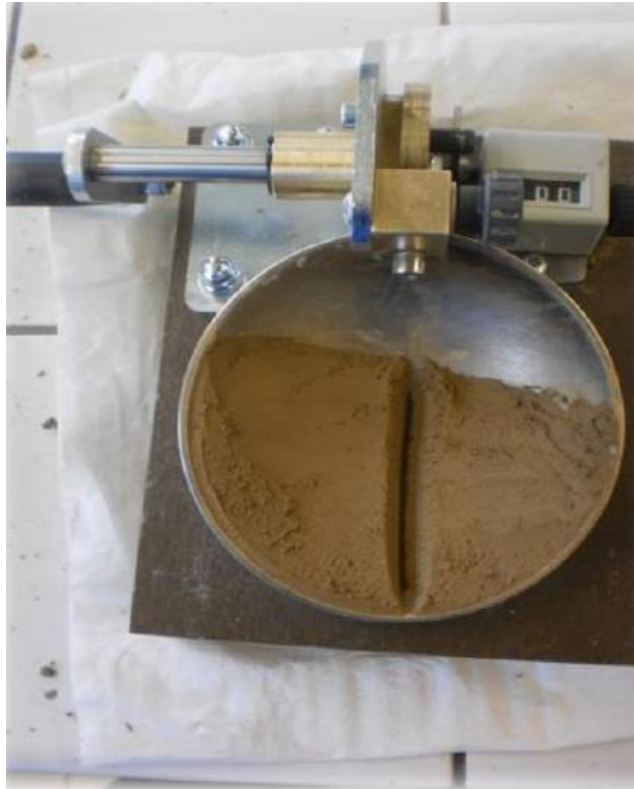
Fig10: Limite de liquidité à la coupelle de Casagrande. (Hanane, 2018/2019)
