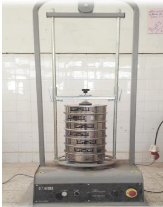
Fig5 : Appareillage de l'analyse granulométrique par tamisage.
