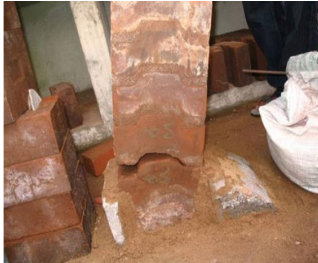
Fig19 : Échec à l'interface liant-mortier
