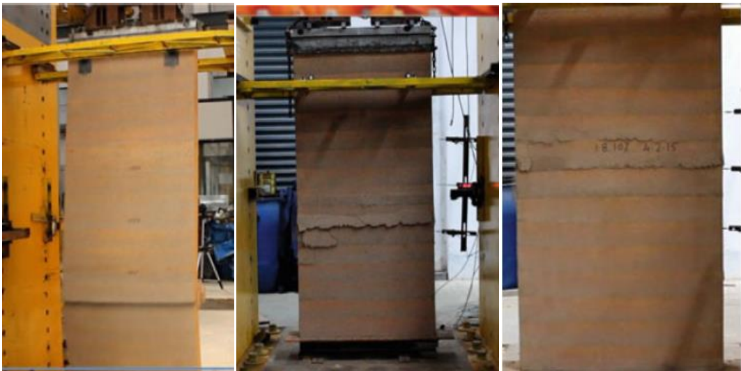
Fig22 : Modèle de défaillance typique pour les murs CSRE sous aucune compression excentrique
