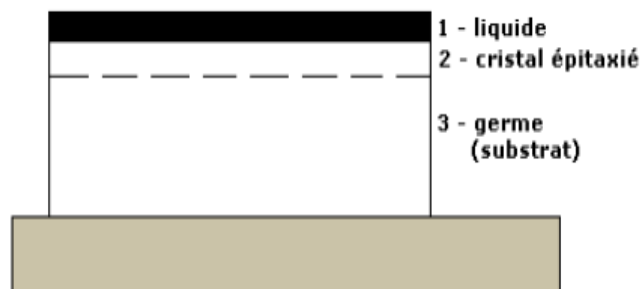
Figure I.4 : Schéma de principe d'une croissance épitaxiale en phase liquide [19].
