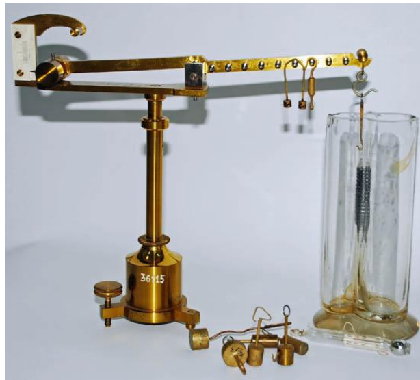
Figure.2 : Photo de la balance de Mohr-Westphal
