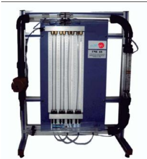
Figure.3 : Photo du banc Hydraulique de mesure de débit
