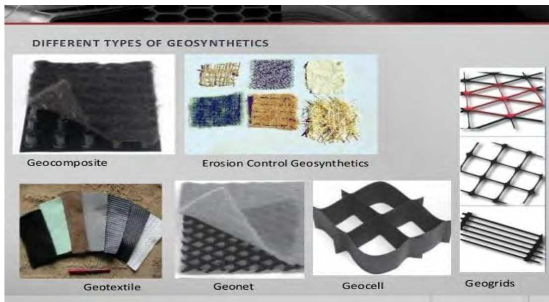
Figure 2.2 : Les principes types de géosynthétique [6].
