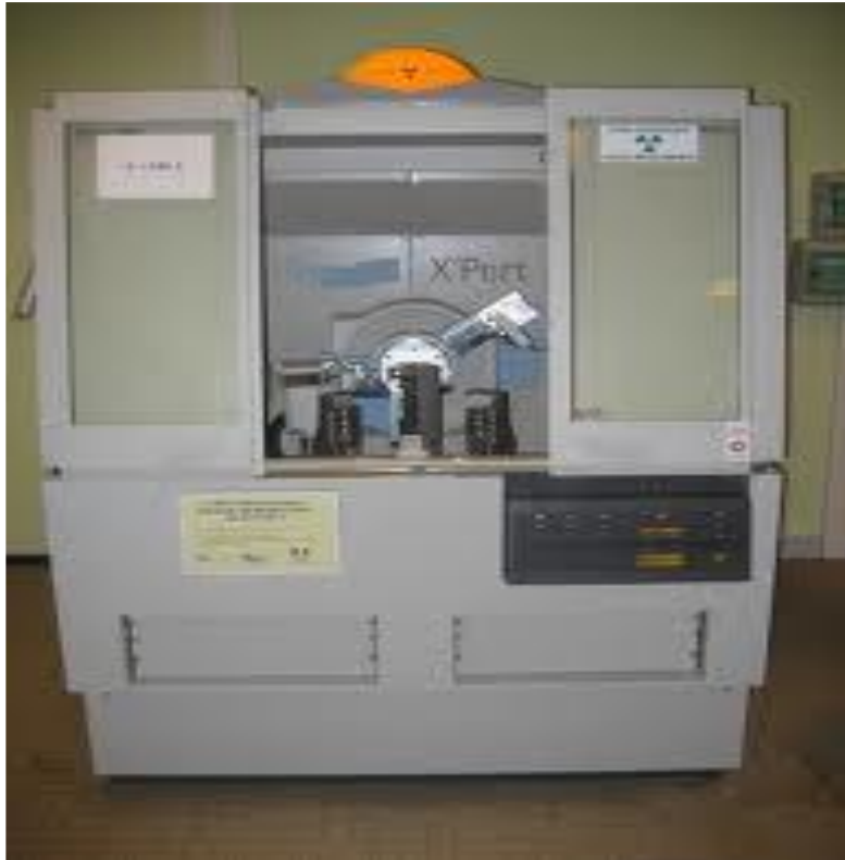
Figure. II.4 : Photo de l'appareil Diffraction des Rayons X (DRX)
