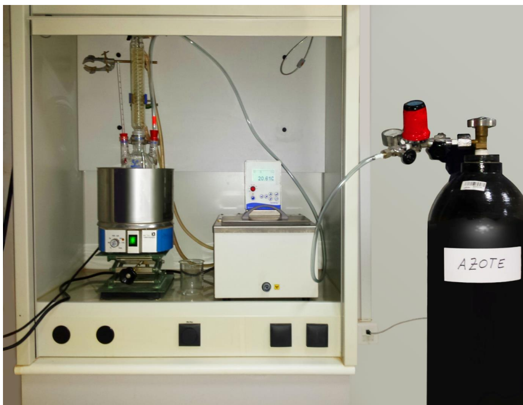
Figure. II.1 : Montage de la manipulation de greffage de la Mt-ETA avec TESPSH
