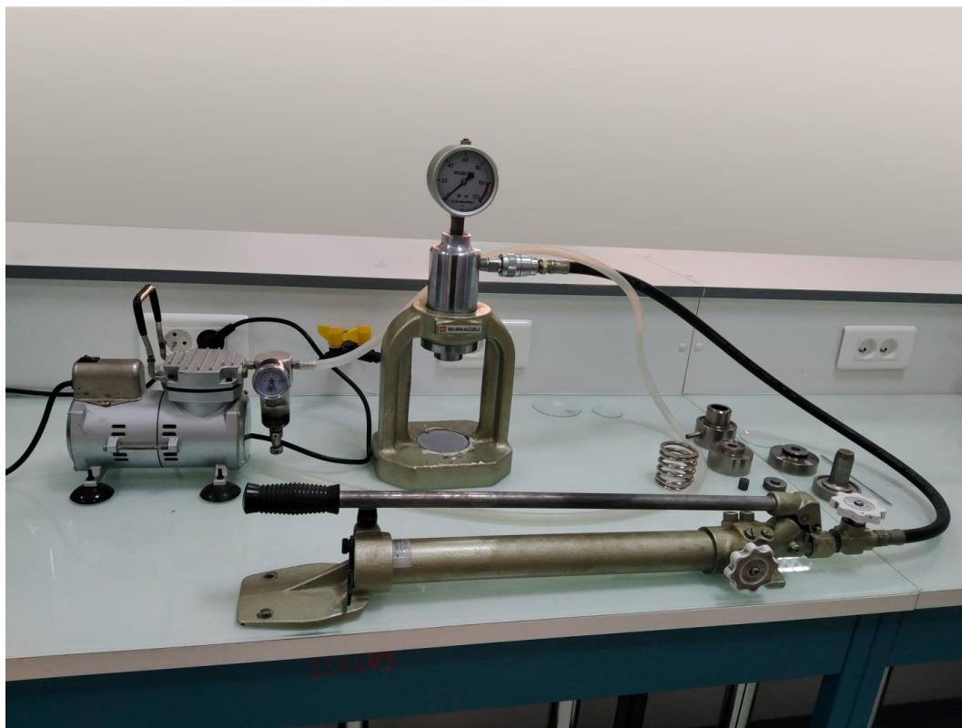
Figure .II.2 : presse de préparation de la pastille KBr.
