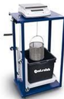
Figure II-3 Méthode de la pesée hydrostatique
