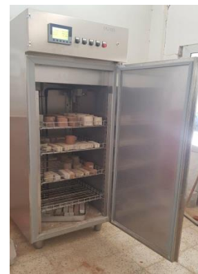
Figure II-16 enceinte climatique pour lecture des éprouvettes
