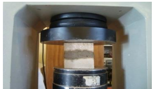
Figure II-19 Essai d'écrasement de l'éprouvette
