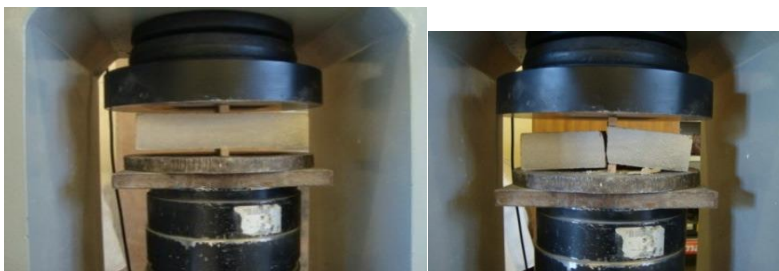
Figure II-18 Essai de traction par fendage
