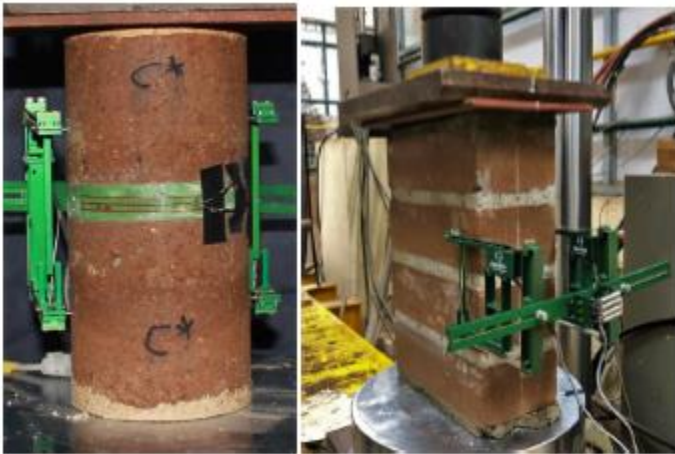
Figure I-41 Essai de compression pour déterminer le module d'élasticité (Ruiz, Zhang, & Al, 2018)
