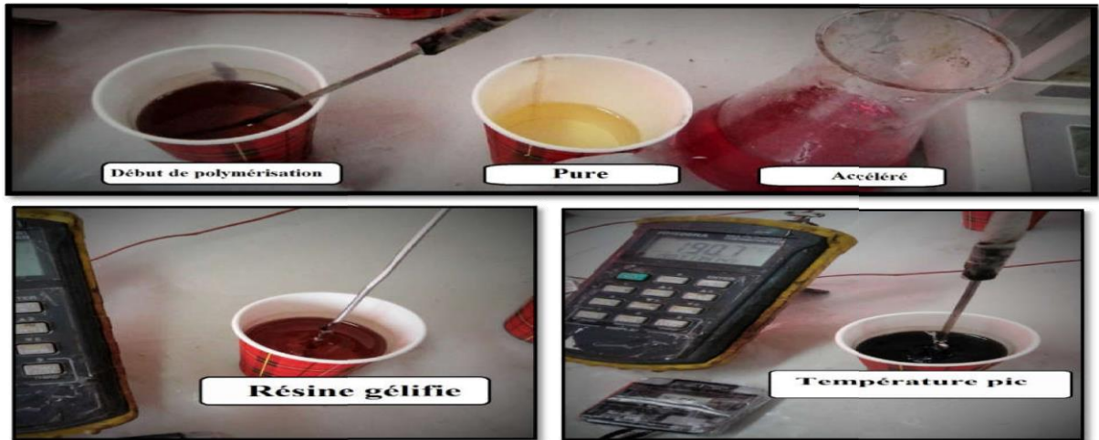
Fig. IV.6: Test de réactivité de la résine.
