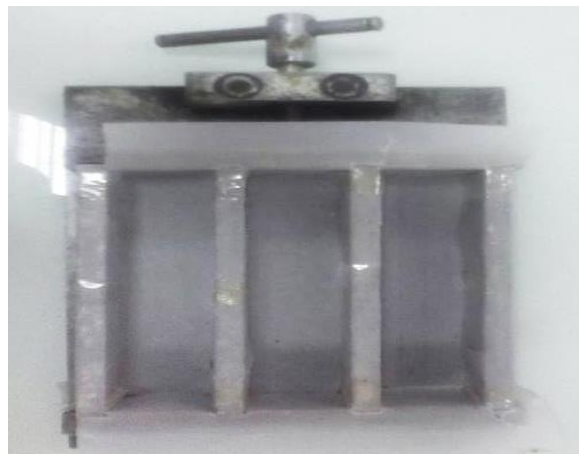
Fig. IV.14: Moule utilisé pour éprouvettes lisses (FTP) de BP.
