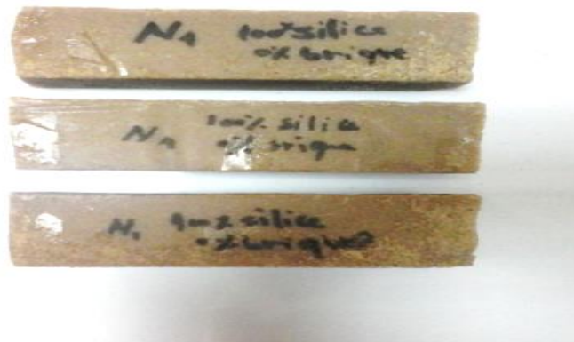
Fig. IV.16: Eproutettes lissés en BP non chargé par filler de brique et non renforcé : N1:BP-00.
