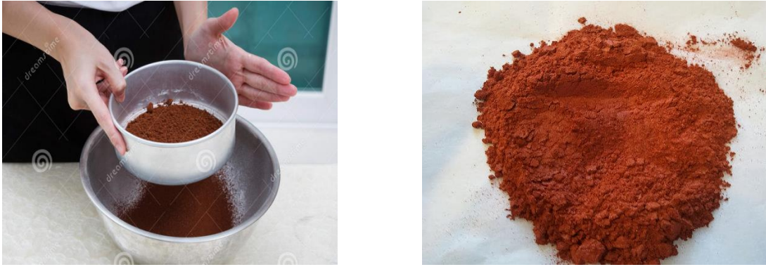
Figure IV. 13: Tamisage de la poudre de brique (tamis 0,08mm).
