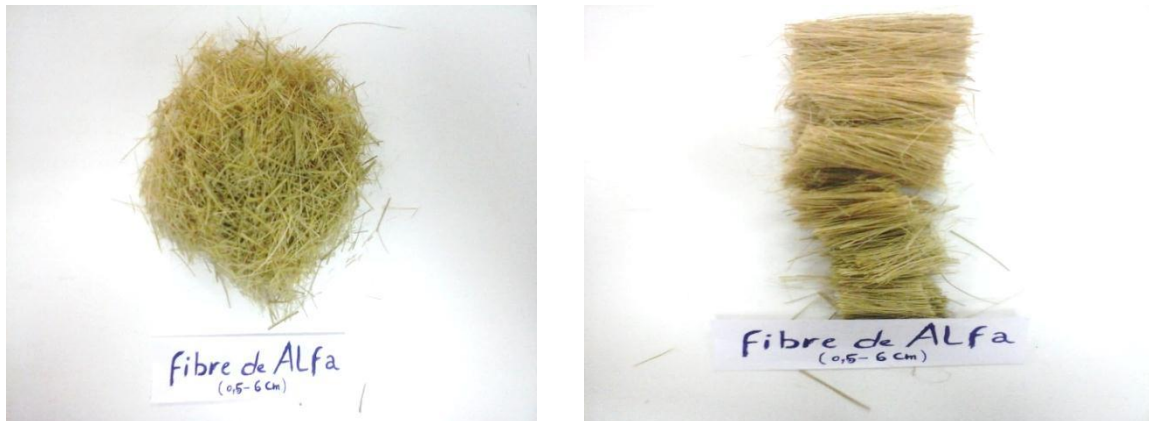
Figure IV. 10: La fibre Alfa découpées en différentes longueurs (0.5 à 6 cm).
