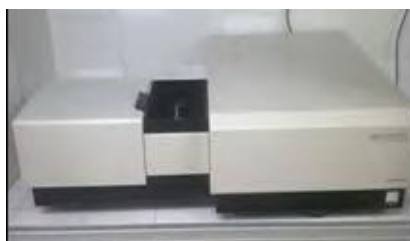
Figure II.6 : Présentation du spectrophotomètre UV-Visible de type (UV-3101PC-SHIMADZU).
