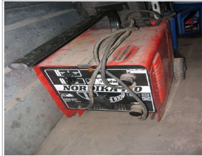
Figure III.3. Poste à souder a l'arc électrique utilisé.
