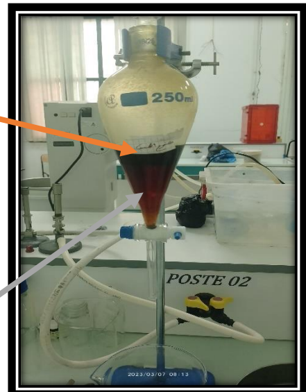
Figure 16: Extraction liquide-liquid Par l'acétate d'éthyle du Cupressus sempervirens L.
