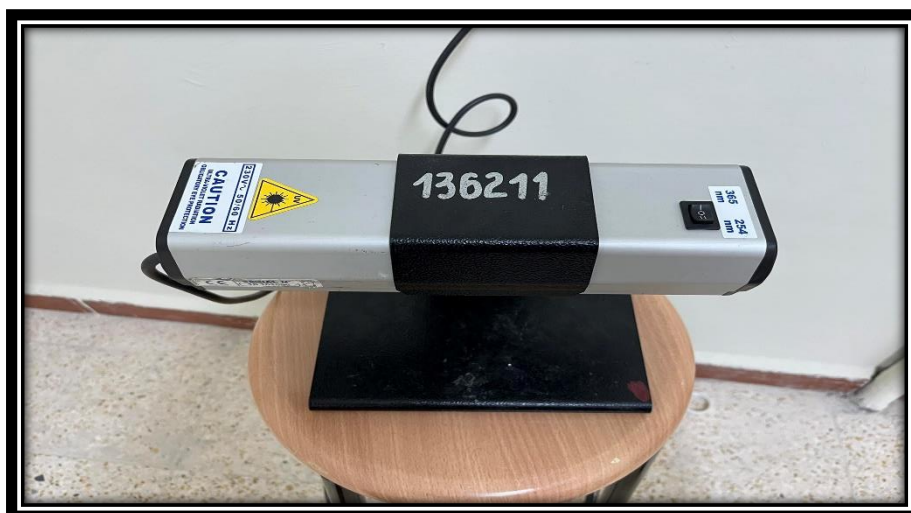
Figure 22 : Photo original Appareil de l'Ultra-violet pour l'observation des couleurs de la séparation.
