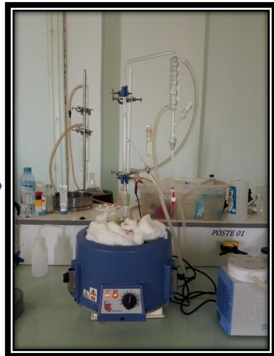
Figure 21: Photo original de Appareil d'hydrodistillation de type de clévenger
