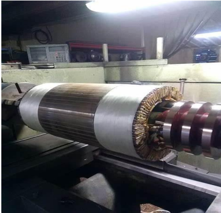
Figure 0.6. Rotor à pôles lisses
