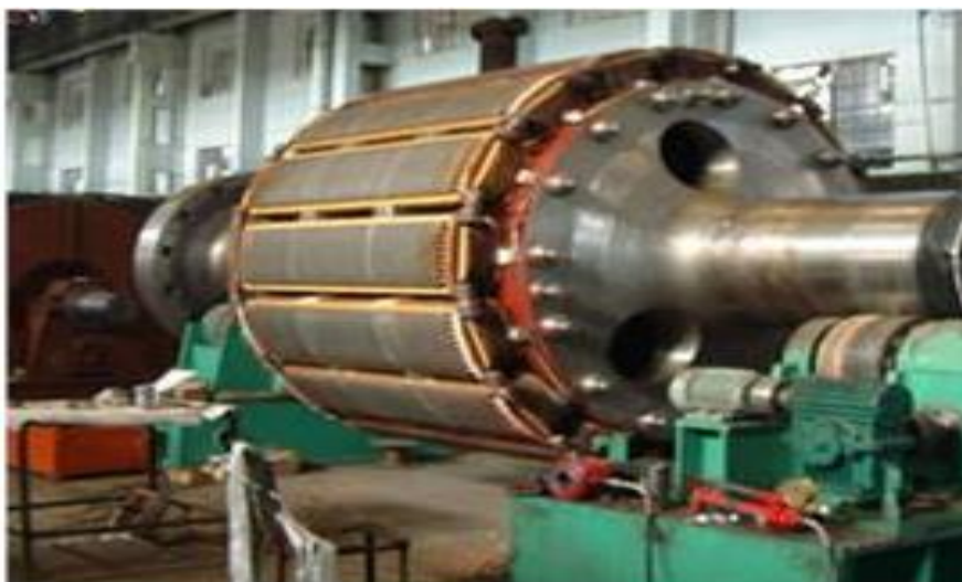
Figure 0.7. Rotor à pôles saillants
