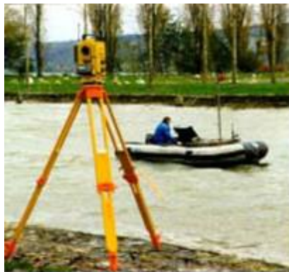
Figure I.10: Estimation de l'envasement par la méthode de nivellement (Tachéomètre).
