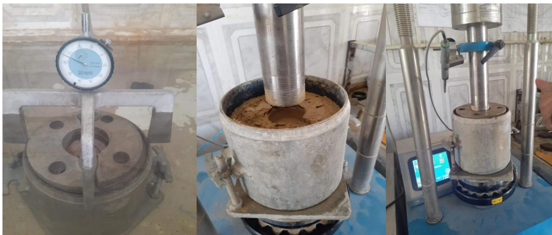
Figure III.11 Vue générale de l'appareil utilisé dans l'I.CBR après immersion.
