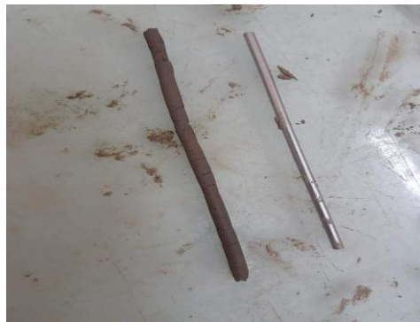
Figure II.8 : Formation des rouleaux pour la détermination de W_p
