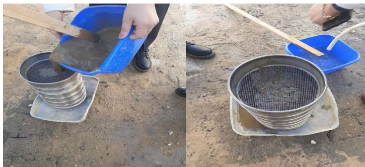
Figure II.3 L'analyse granulométrique par des tamis manuellement humide
