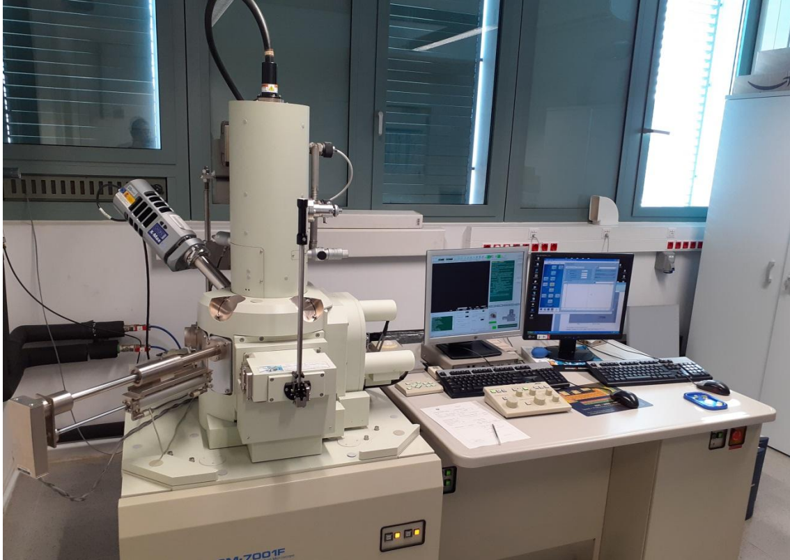
Figure 2.4 : Photo de Microscope électronique FEG-SEM.
