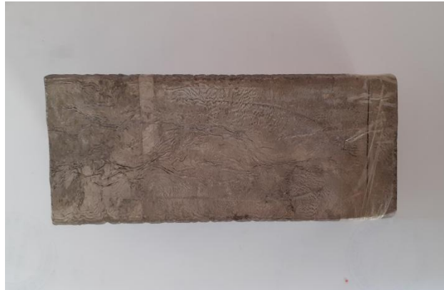
Figure 2.1 : Présentation de l'échantillon Mg-0.3Ce (% poids) sous forme de bloc.
