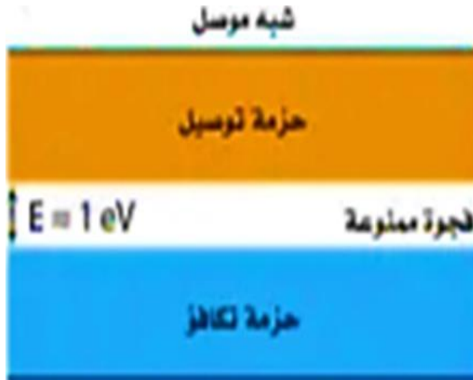
الشكل 11.I: يوضح حزم الطاقة في اشباه الموصلات
