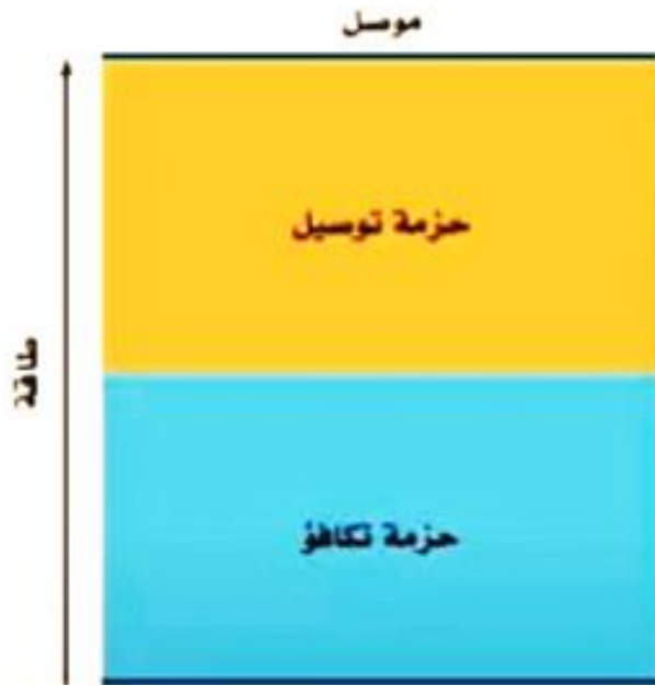
الشكل 9.I: حزم الطاقة في المواد الموصلة
