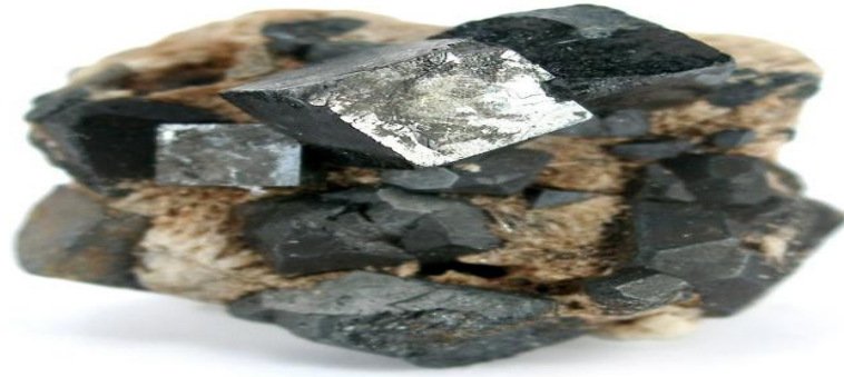
الشكل 1.I: بيروفسكايت تيتانات الكالسيوم ( CaTiO_3 )
