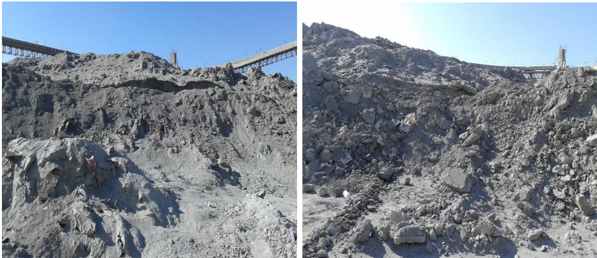
Figure II-1 : déchet de ciment hydraté dans la cimenterie Lafarge – Hammam Dalaa
