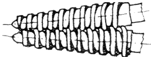
Fig. (I.9) : Organe malaxeur à vis conique
