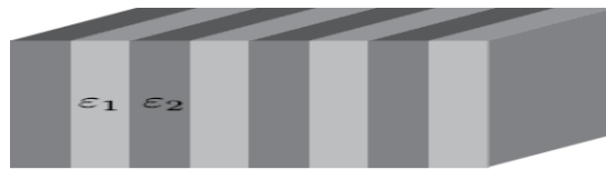
Figure.I.4 : Schéma d'un miroir de Bragg constitué d'un milieu diélectrique périodique fini.
