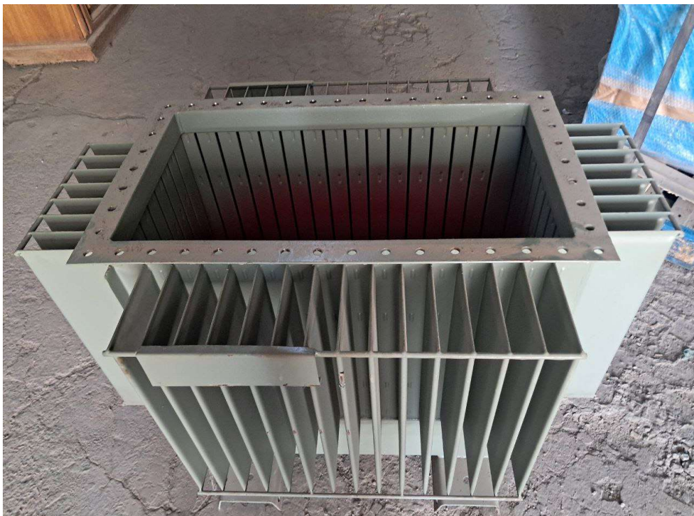
Figure (IV.11) : fabrication de la cuve
