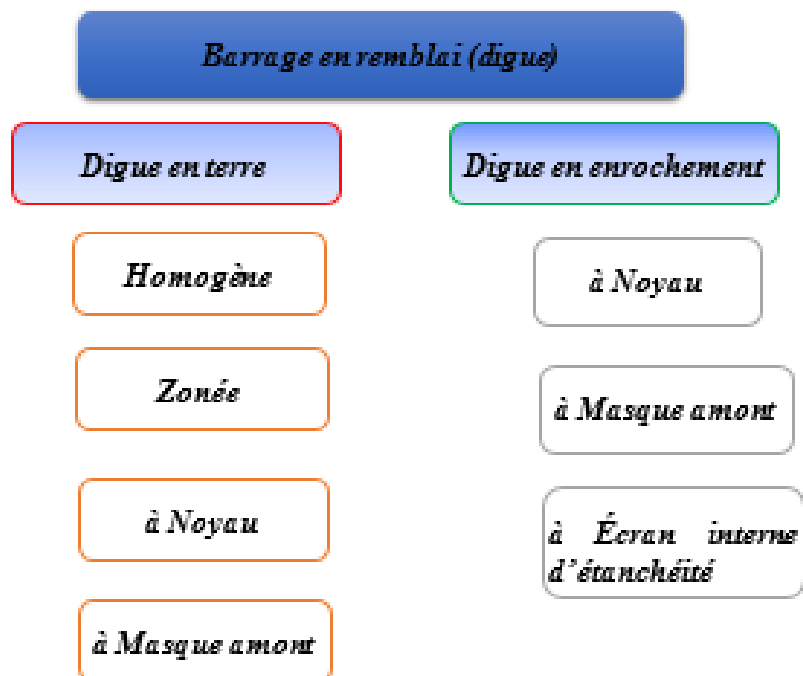
Figure I. 5 Différents types des barrages en remblai
