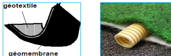
Figure I. 40 Structure d'un géocomposite
