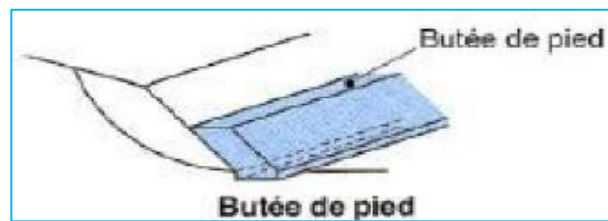
Figure I. 24 Chargement du pied (Sellami S et Belamri S, 2014.)
