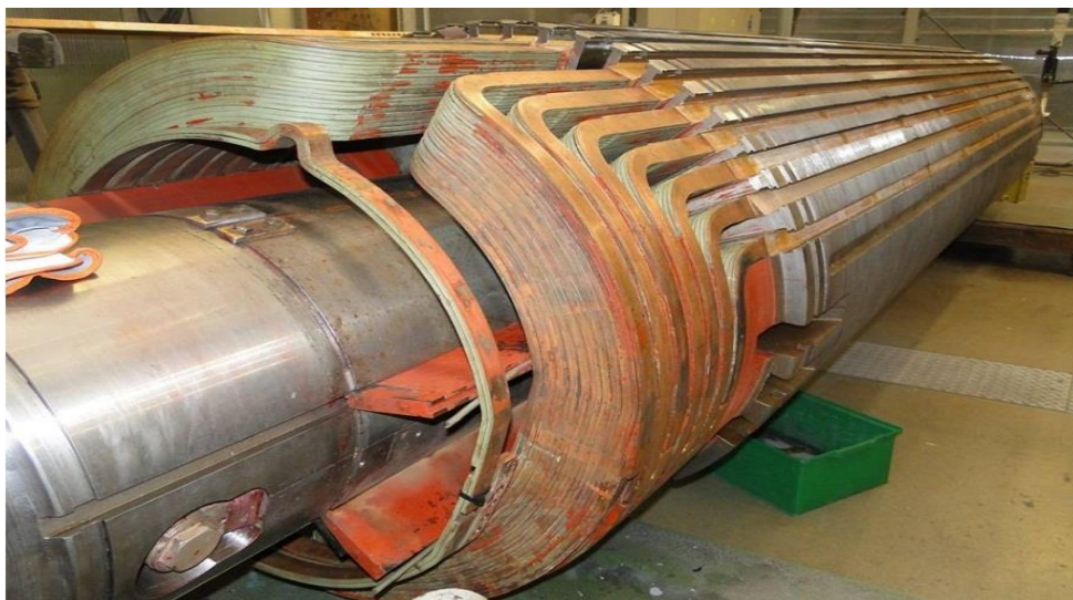
Figure I.8 : Rotor à pole lisse d'un alternateur Ansaldo [4]
