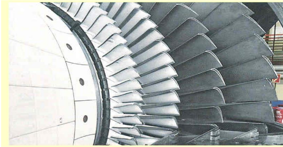
Figure I.5 : Les quatre étages de la turbine [2]
