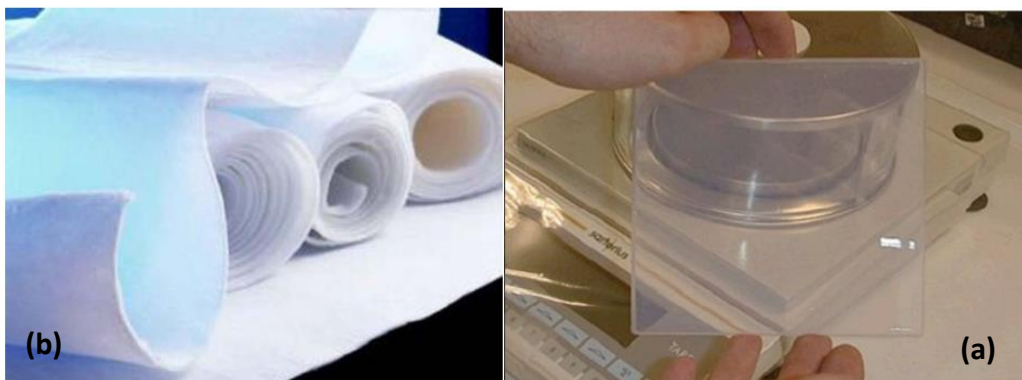
Figure I.14 : Aérogel de silice après séchage supercritique (a) [14]
