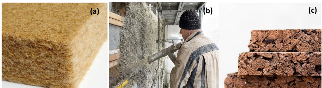
Figure I.11 : Isolants d'origine végétale : (a) laine de bois, (b) béton de chanvre et (c) liège expansé [22]
