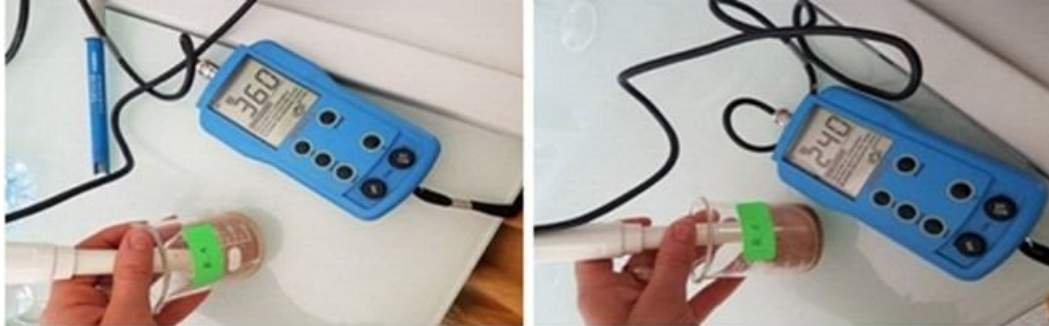
Figure 12: La Mesure de pH et la Conductivité électrique (CE).
