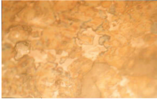
Figure 2.1 Microphotographie du clinker du CPJ de Sour-El-Ghozlane (Grossissement 400).
