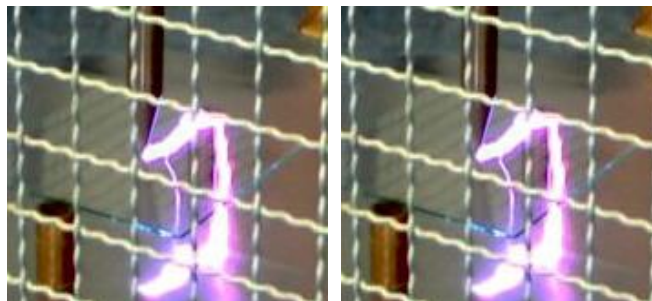
Figure I.7. Décharge par étape.
