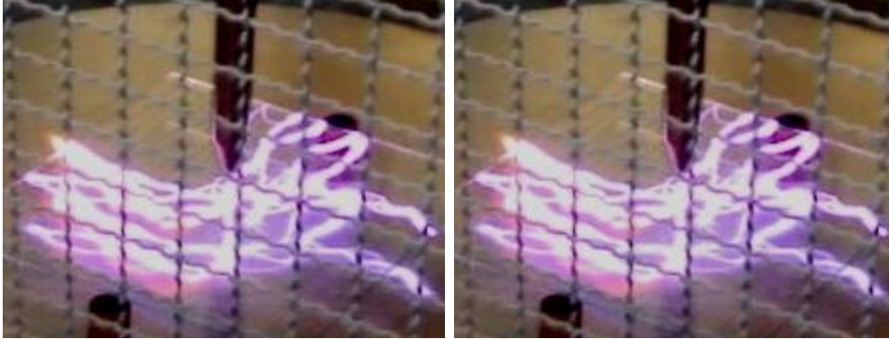
Figure I.6. Décharge glissante. Laboratoire de HT de l'université de Biskra.
