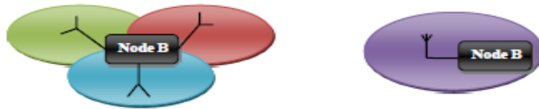
NodeB avec Antenne sectorielle
