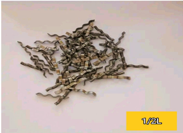
Fig. III. 1 Géométrie des fibres utilisées.
