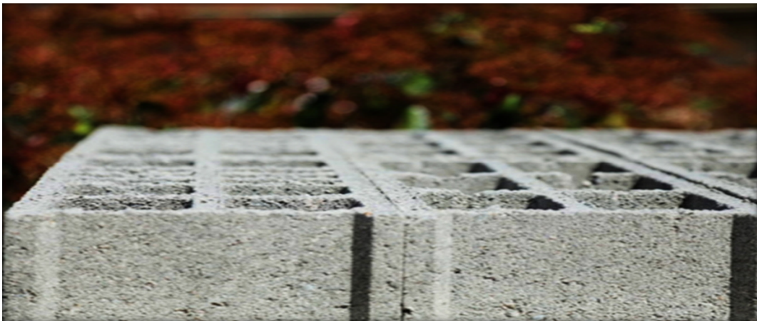
Fig. I. 3 Un parpaing après formage dans sa forme définitive
