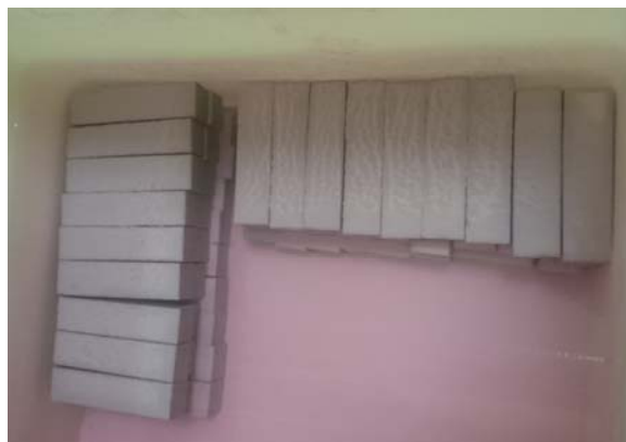
Fig. IV.7. La cure des mortiers normalisés.
