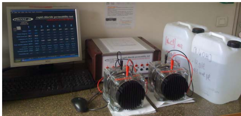
Fig.IV.8. Essai de migration des ions chlorure.
