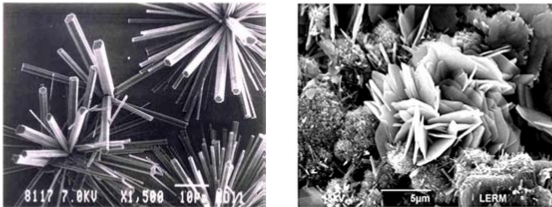
Fig. III. 2. Image MEB –Gauche : Ettringite AF_t – Droite : monosulfoaluminate de calcium AF_m . [57]
