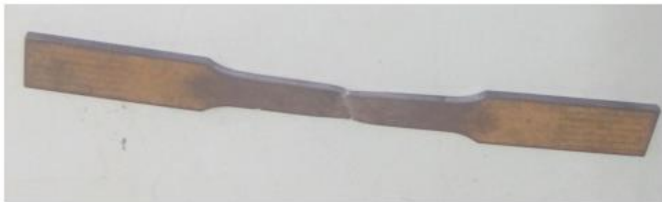
La figure V.11 : Rupture du métal de base (sans soudure) après l'essai de Traction
