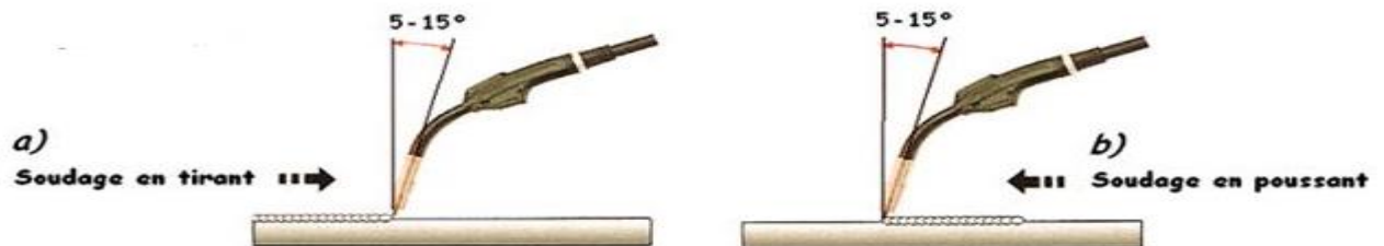
Figure III.19: Soudage en tirant ou poussant [53]
