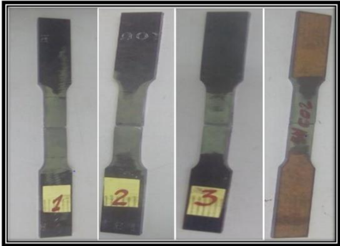
Figure V.12: Rupture des éprouvette S1, S2, S3, S4 après l'essai de traction indiquées par 1, 2, 3, et sans CO2 respectivement
