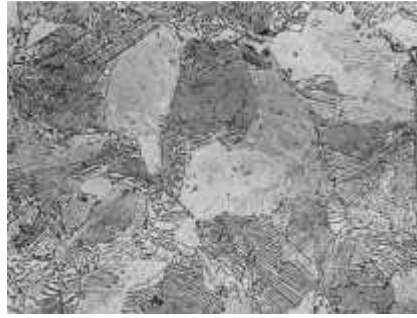
Figure I.05 : Structure perlitique Acier à 0,8 % C - 0,21 % Mn - 0,22 % Si Traitement : 800 °C (30 min) – four Attaque Natal (3 %) Grossissement : 900. [11]
