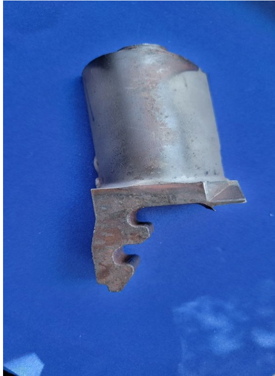
Figure 3.2: la pièce à étudier (ailette turbine mobile)
