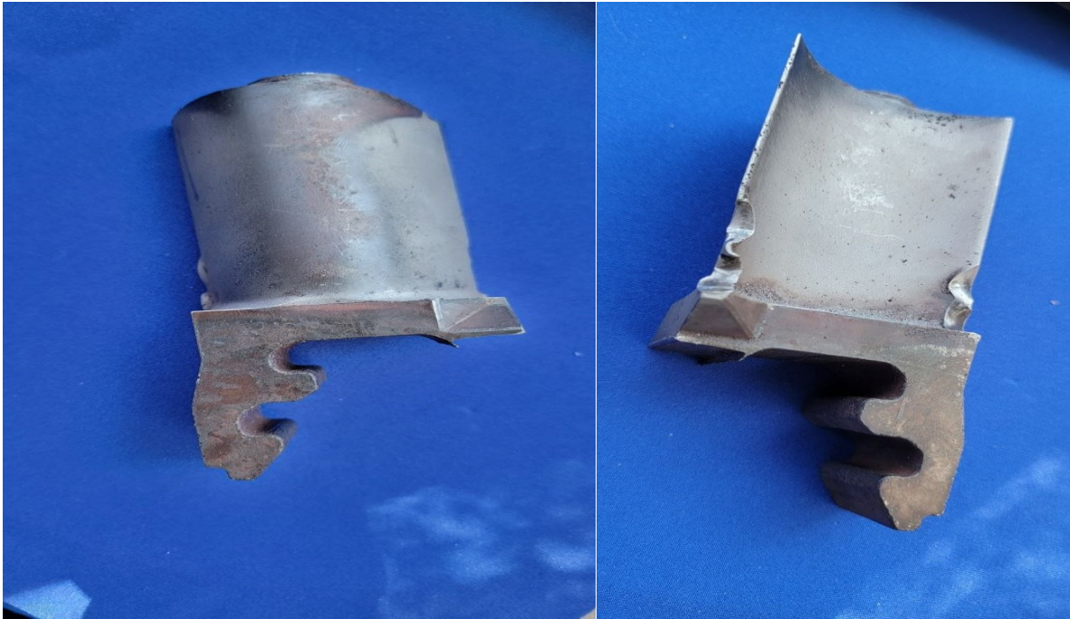
Figure 2.2 : Ailette endommagée (ailette turbine mobile)
