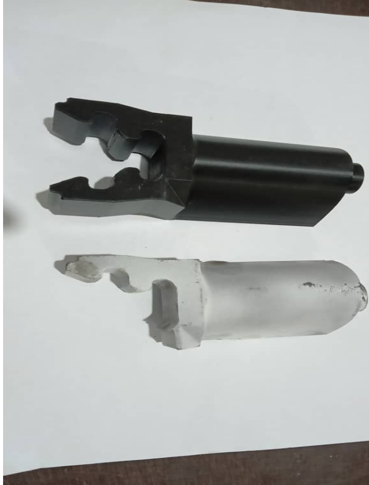
Figure 3.17 : la pièce finie obtenue après fabrication par rapport à la pièce endommagée
