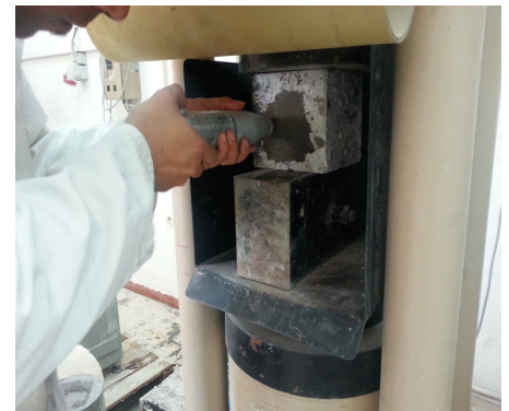
Figure III. 5 : Essai de scléromètre
