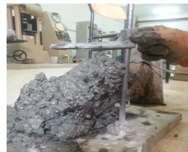
Figure III. 4 : Essai au cône d'Abrams
