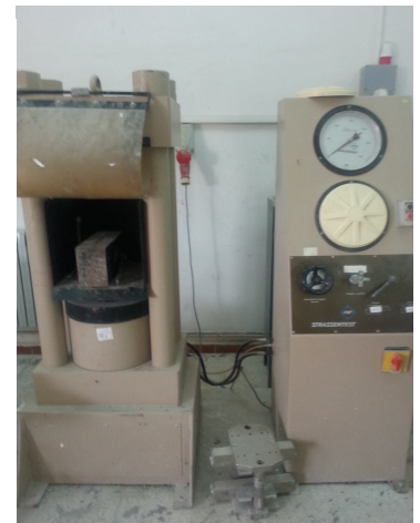
Figure III.12: Essai de Brésilien
