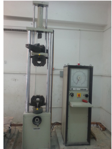
Figure III.13: Essai de traction par flexion.
